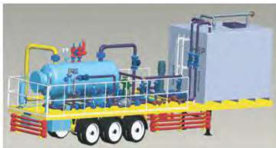
图 5-6 拖车式返排分离器和返排罐示意图
